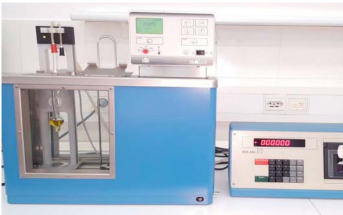
Viskozimetar Schott – ispitivanje viskoznosti ulja
