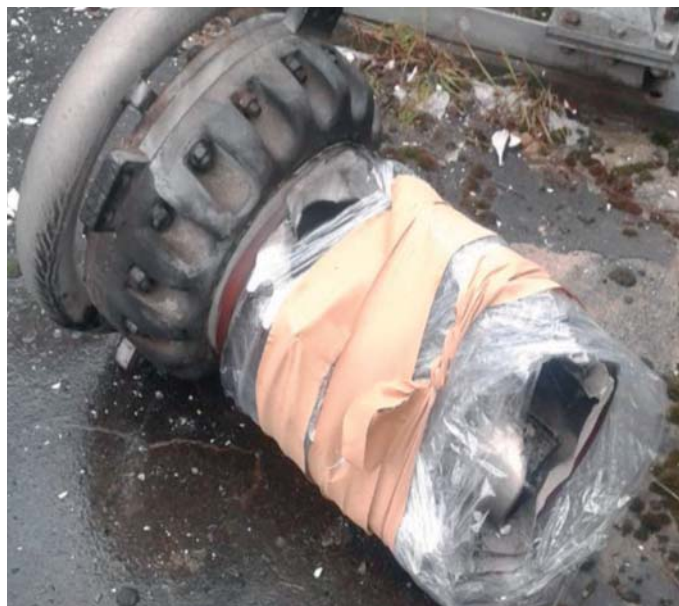
Dio havariisanog prekidnog elementa
