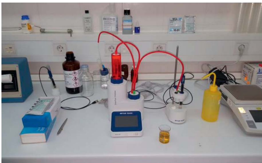
Titration Mettler Toledo – ispitivanje kiselinskih produkata degradacije ulja
