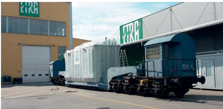
Auto-transformator 220/115/10,5 kV, 150 MVA, natovaren na specijalni željeznički vagon
