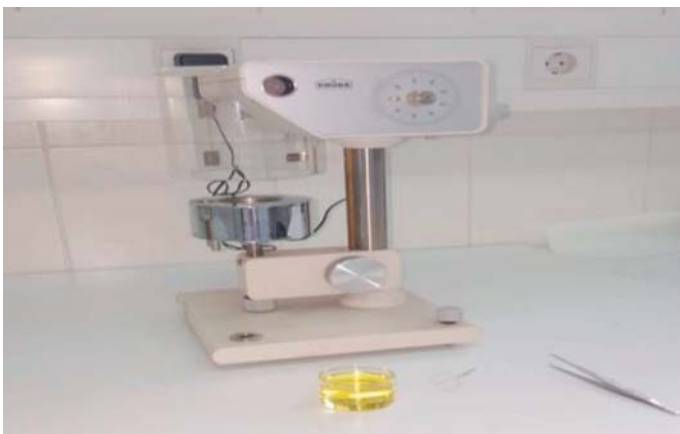
Tenziometar K8 KRUSS – ispitivanje međupovršinskog napona ulja
