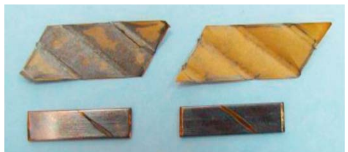
Ispitivanje korozivnosti transformatorskih ulja prema IEC 62535:08
