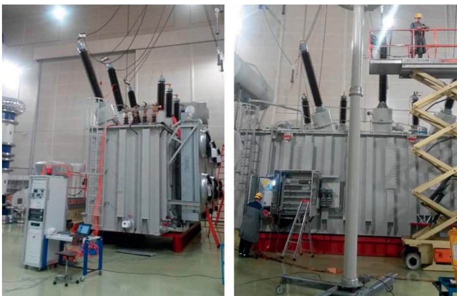
Ispitivanje auto-transformatora u tvornici proizvođača
